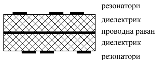
Слика 2. Вишеслојна структура за реализацију филтра (скица попречног пресека у коме нису учтане вије). Предложени филтар има резонаторе који се добијају модификовањем резонатора-укоснице, тако што се трака штампа у више слојева. Структуру филтра чини проводна плоча у сендвичу између две диелектричне плоче, а на диелектричним плочама се штампају траке резонатора.
